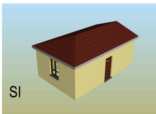
Fig. 4 – Copertura a padiglione
